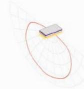
**Curva no Eixo 90-270° ou Eixo Transversal:** É o desenho da irradiação de luz em um plano no sentido transversal à luminária.
